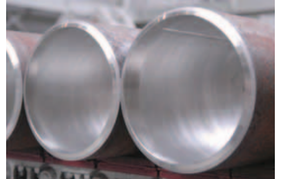
Butting produziert metallurgisch und mechanisch plattierte Rohre
